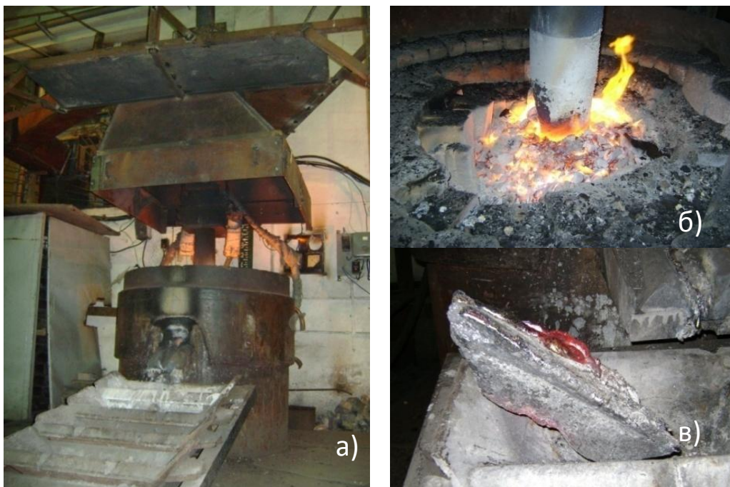
Рисунок 1 – Общий вид однофазной руднотермической печи (а), состояния колошника (б) и слиток сплава полученной, бесшлаковым способом (в)
